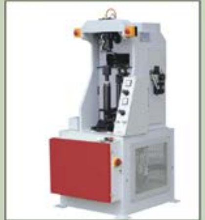
KALÇARIZMA ÖKÇE PİSTARIZMA
